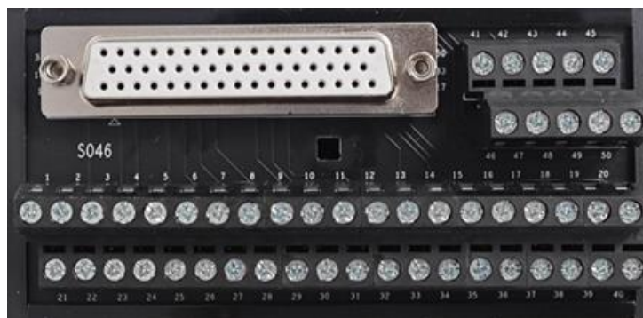
图 3.1 外置 IO 板卡
